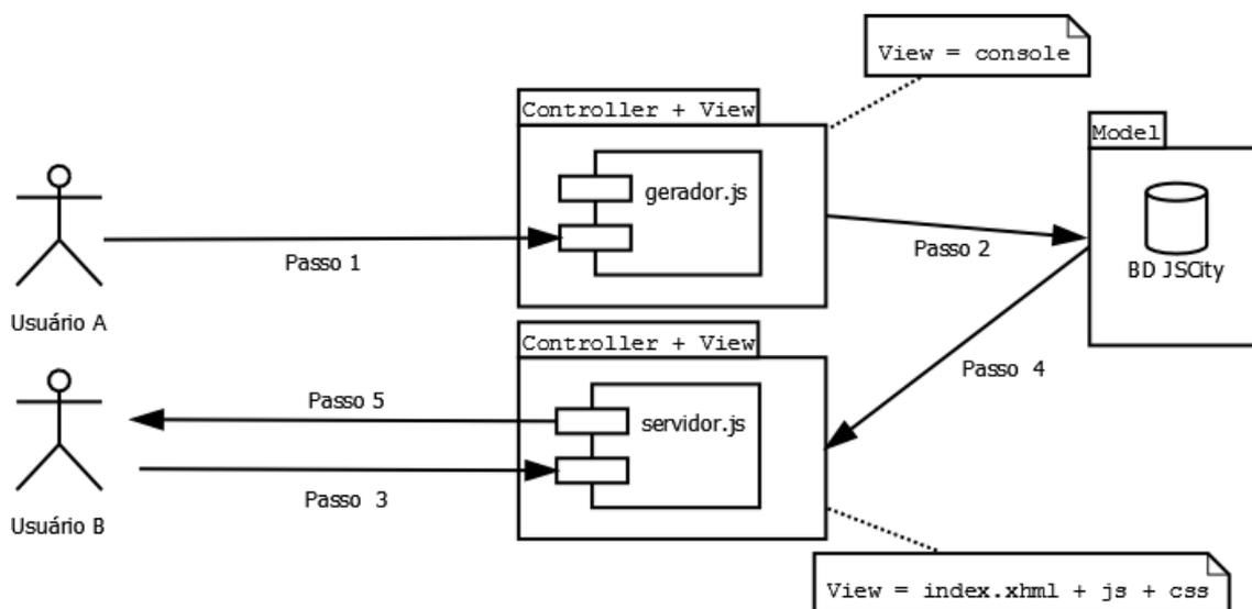
Figura 2: Diagrama de Componentes da Ferramenta JSCity
